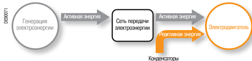
Реактивная энергия производится конденсаторами. Энергосбытовая компания не выставляет счет за реактивную энергию.
